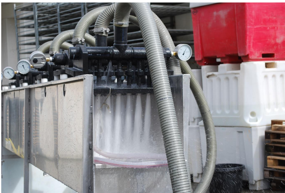
Figur 4 Fossen under testing hos Stave AS på Stadlandet. Topelementene er alle utstyrt med manometer. Det nærmeste topelementet ble ikke brukt i forsøkene med fisk, men kun til målinger.
