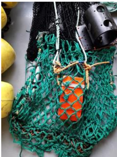
Figur 10. Montering av SeineEye i notlinpose sammen med vinkelsensor som plasseres parallelt med SeineEye. Til høyre er forklaring på Z-vinkel ( Z=0 når notsensor peker horisontalt, Z<0 når notsensor peker ned og Z>0 når notsensor peker opp).
