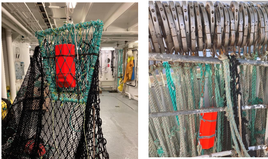
Figur 7. Montering av notsensor i ramme noen meter under flåtelen og i ringene.
