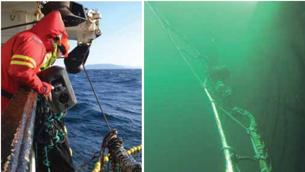
Figur 5. GoPro-kamera i housing festes til geila.
