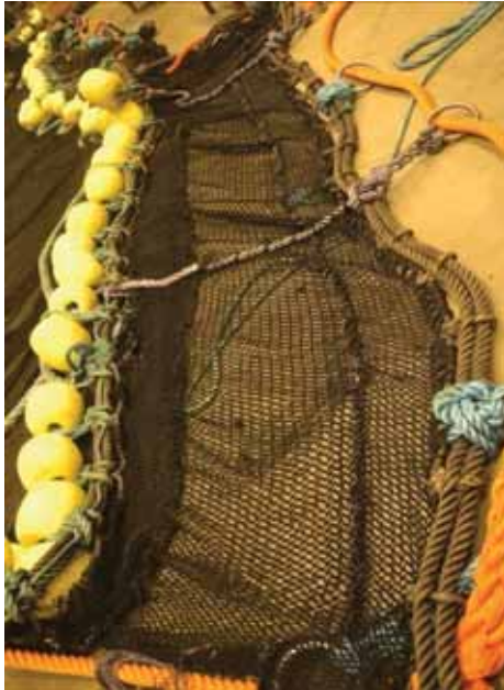
Figur 12. Den ”nye” flåsnurpa ble montert på nota ved Fiskenet i Manger. Det ekstra ”skjørtet” var 1 m høyt, 25 m langt og var montert 30 cm nede på notas garnering.
