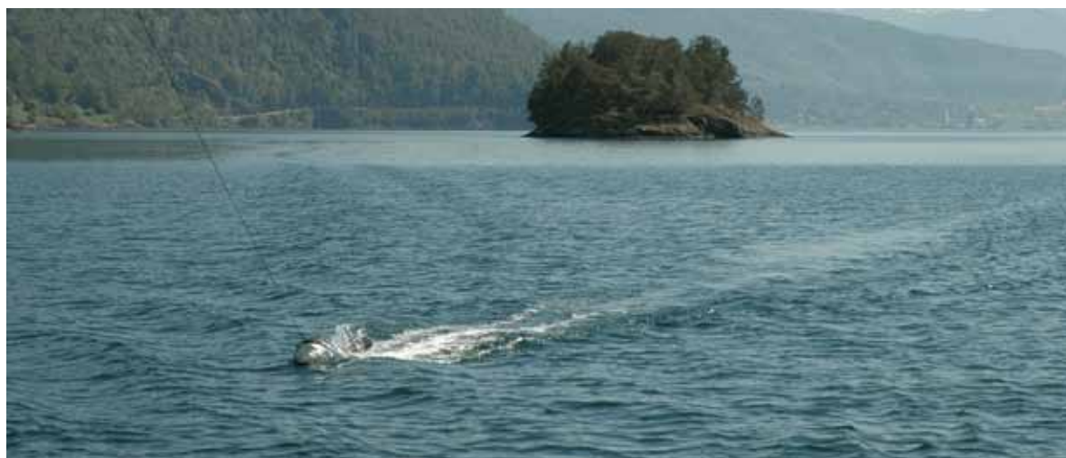
Saltholdighet og temperatur i overflaten måles med en slepesonde i Etnefjorden. Salinity and temperature are measured with a towed sensor in Etnefjorden.
