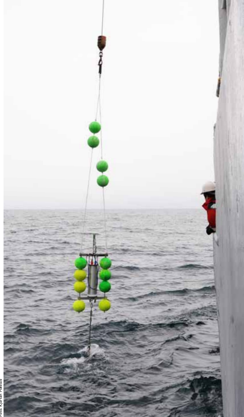
Hydrofon bøyer som blir satt ut i forbindelse med Oljedirektoratets seismikkundersøkelse i området Nordland VII utenfor Vesterålen sommeren 2009.
