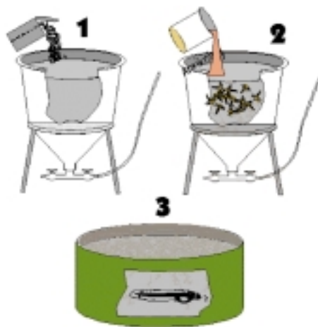
Figur 6. Skisse av Artemiaproduksjon. 1. Artemia cyster (evnt. decapsulerte) tilsettes klekketanken (27 °C, 22 ppt salinitet). 2. Etter ca 24 timer siles, skylles og overføres Artemia til anrikningstanker (27 °C, 34 ppt salinitet) hvor anrikningen tilsettes. 3. Etter ytterligere 24 timer sies Artemia, skylles, og føres ut til larvene.
