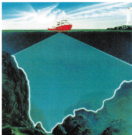
Kartlegging av dybdeforhold med multistråle ekkolodd (Ill. SIMRAD)
