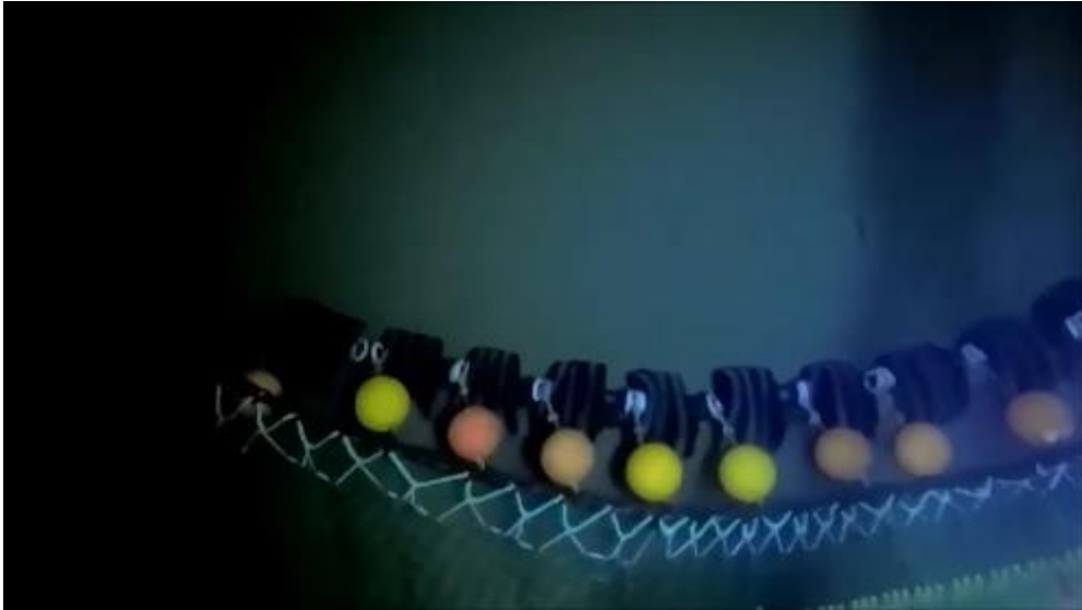
Figur 3. Øyeblikksbilde fra GoPro kamera festet i taket av Campelen-trålen, rett over giret. Trålen er rigget med Nordsjørigging, dvs. påmontert 50 girtamper (50 cm lange) mellom gir og fiskeline, med en 8" trålkule på hver girtamp.
