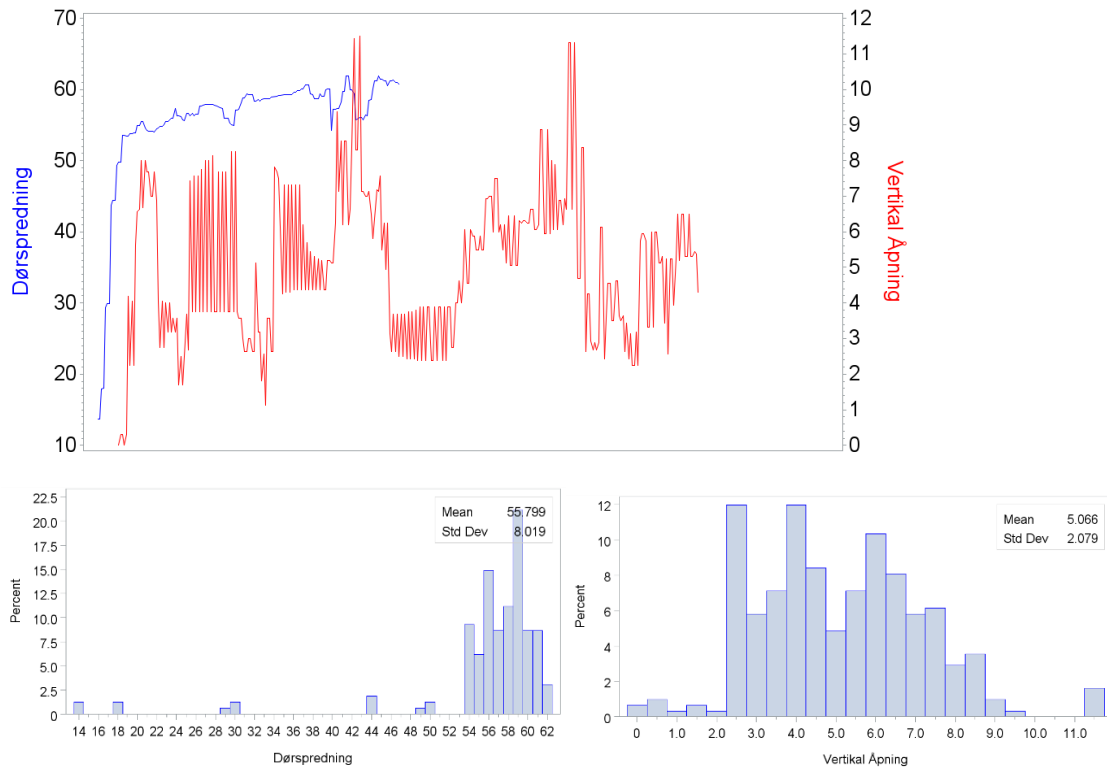
Figur 5. Hal nr. 31 med Campelen 1631, strepping 120 m foran dørene. Sandbunn i Norskerennen. Både dørspreidningen og trållåpningen er for høy.
