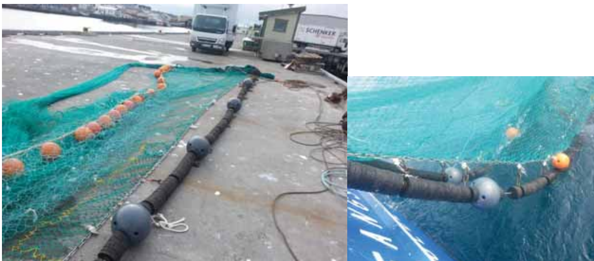
Figur 5 . Skisse og bilder av rullegearer brukt i forsøket. Bobbinskulene er med 11" dia. med hull og i plastmateriale.
