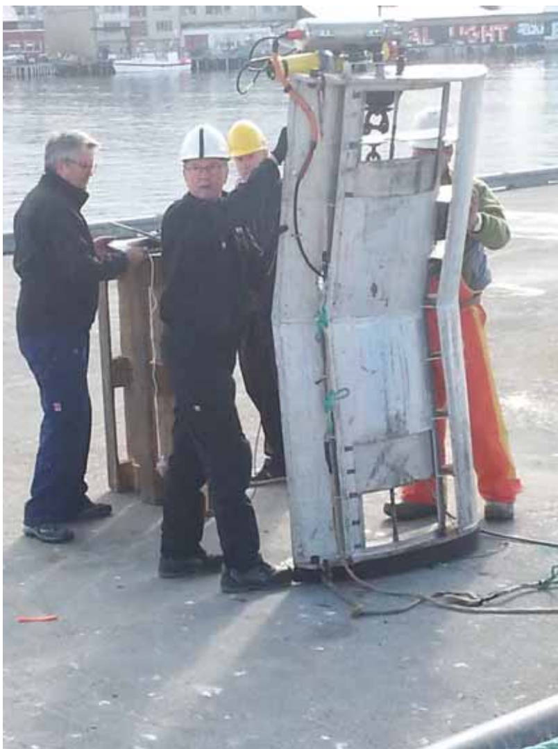
Figur 6. SeaFlex tråldør med luker som kan åpnes og lukkes.
