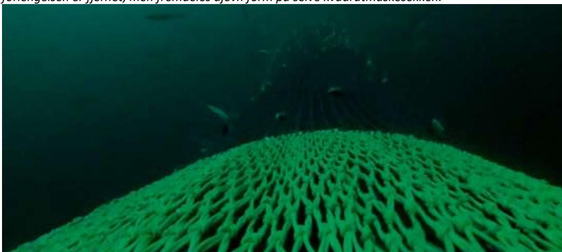
Kvadratmaskesekk montert på snurrevaden etter at den ble kortet ned med 14 m til 250 maske omkrets, filmet forfra. Sekken er mer utspilt på tvers.
