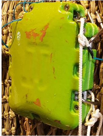
Bilde 1: Sekkeutløseren på trålsekken.
