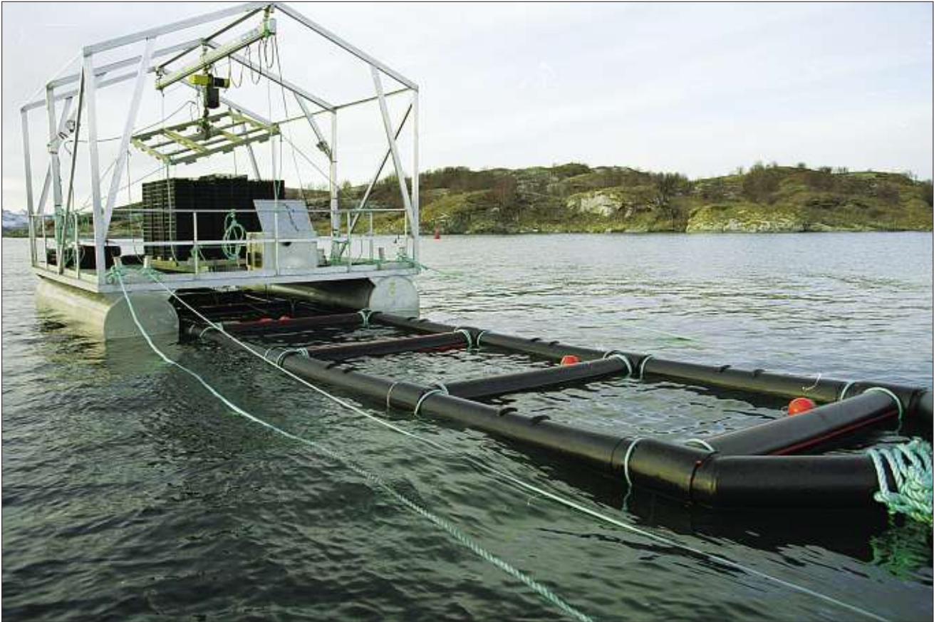
Figur 5.8.2.3 Sjøbasert oppbevaringsteknologi for oppføring/oppdrett av kråkebolle. Sea based holding technology for feeding and rearing of sea urchin.
