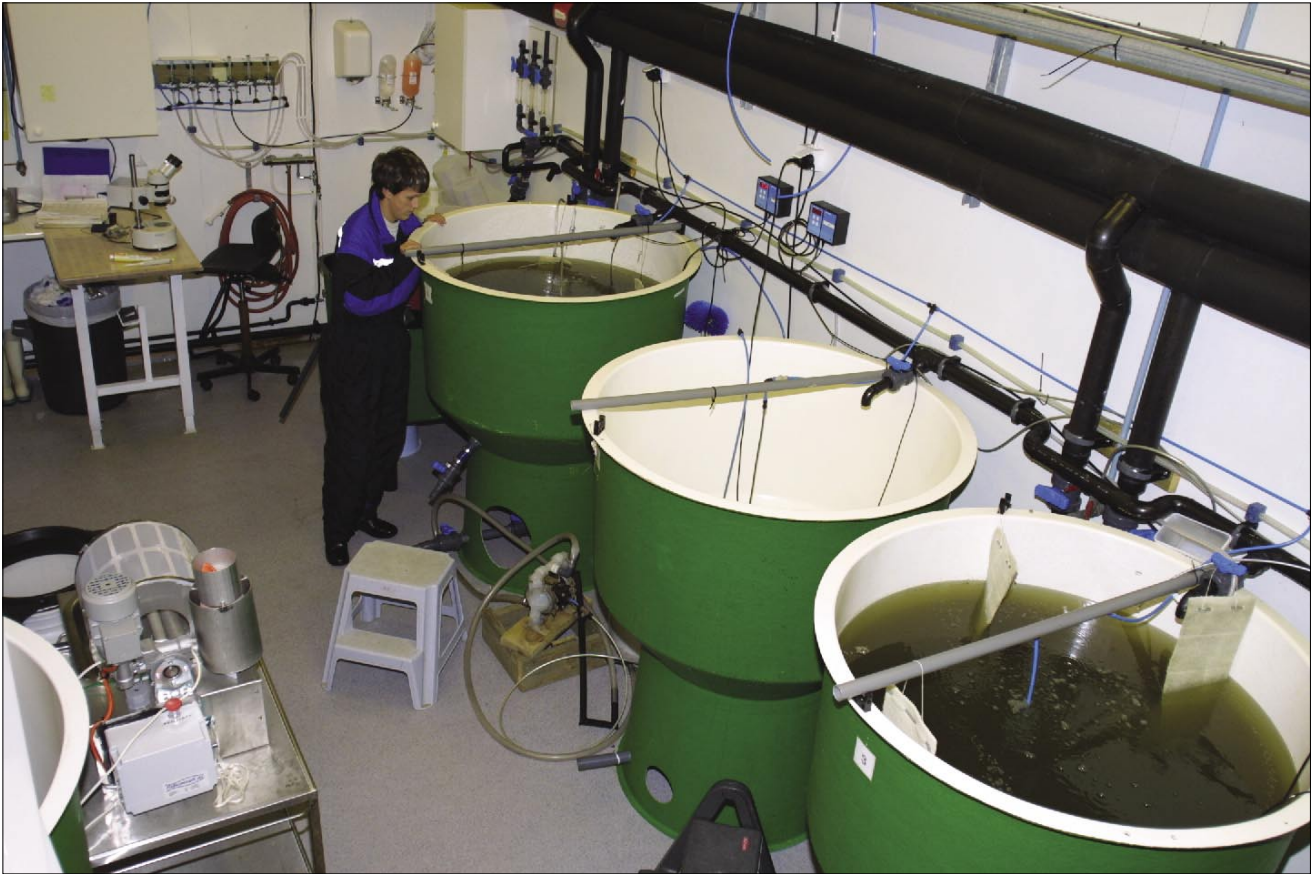
Figur 2 Produksjonstanker (600 liter) for høytetthetskulturer av rotatorier. Production units (600 liters) for high density cultures of rotifers.
