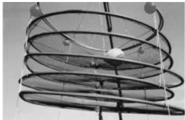
Figur 1 Hyllesystem for utplassering i store kar bestående av nett utspent mellom rørringer av PEH (Kilde: Aqualine A/S, http://www.aqualine.no/ ). Shelf system for use in large halibut tanks, made of nets and PEH-pipes.
